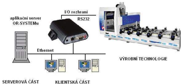
Obr. 3: Komunikace OR-SYSTEMU s výrobním zařízením
